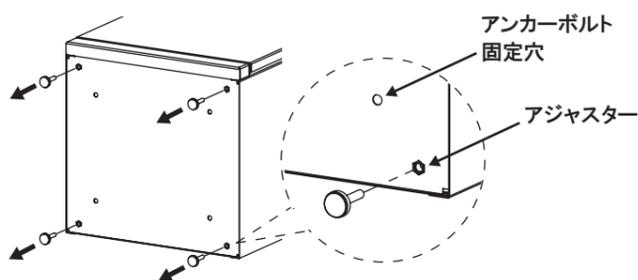
④ 以下の取付ピッチを参考に、アンカーボルト施工を行ってください。
