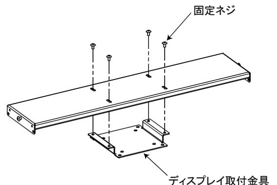
■取り外したディスプレイ取付金具をディスプレイ背面の穴に合わせ、付属のディスプレイ取付ネジを使用し固定してください。(図3)
