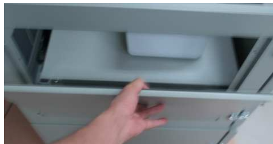
図1 5 側面パネル取外し作業
