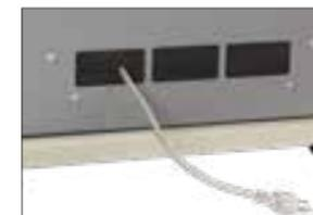
ケーブルを上下から挟み込むことで、埃の侵入を防ぎ、尚且つケーブルが傷つかないように保護をしています。上段の左右のネジを緩めることでゴムスポンジを上下に開閉できます。
