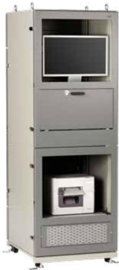
防塵ラックとは、搭載するパソコンや情報通信機器を粉塵によるダメージからまもるための密閉筐体を指します。一般的な情報通信機器用の(被せたり、囲ったりする)ラックとはまったく異なる性質を持っています。例えば、防塵ラックは密閉性を重視しますが、一般的なラックは機器の放熱を妨げない通気性を重視して設計されています。
