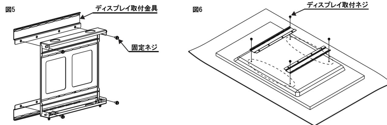
■取付けるディスプレイのネジ穴ピッチ(VESAピッチ)によってディスプレイ取付金具の向きが変わります。図7を参考にディスプレイ取付金具の向きを合わせ取付けてください。(図7)
