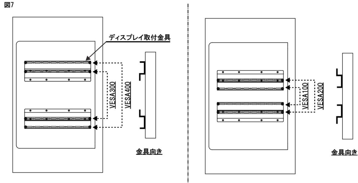
■VESA穴がディスプレイの中心にない場合図9のようにディスプレイ取付金具のセンター穴をおおよそディスプレイの中心に合わせて取付けてください。(図8)
