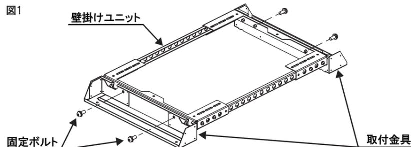
■壁掛けユニットの長さを使用ディスプレイに合うように調整してください。(図2)
