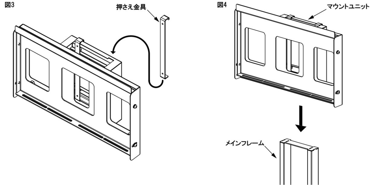
■固定する高さが決まりましたら、マウントユニット背面の上下左右4ヶ所のネジ穴に付属の六角穴付ボタンボルト M6×20をしっかりと締め付けマウントプレートを固定してください。(図5)
