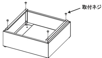
④ チャンネルベースの上にBOX本体を載せ、ベース付属の取付ネジ(M4×6)で4箇所しっかりと固定してください。
