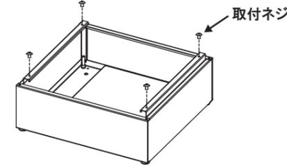
③ チャンネルベースの上にボックス本体を載せ、先程取外した取付ネジ(M4×6)で4箇所しっかりと固定してください。
