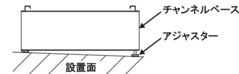
② チャンネルベース上部に取付られている取付ネジ(M4×6)を取外してください。
