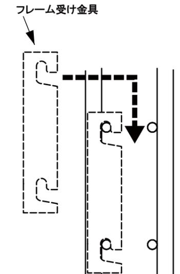
② フレーム受け金具を覆うようにフレーム取付金具を引っ掛けて押し込みます。
