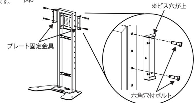
■ 【プレート固定金具(左・右)】に【フックプレート】を取り付けます。プレート固定金具(左・右)正面の上穴に六角穴付ボルトM8×20・スプリングワッシャー・平ワッシャーを軽くとめ、フックプレートをひっかけてください。フックプレートひっかけたら、図7のように正面から六角穴付ボルトM8×20・スプリングワッシャー・平ワッシャーにて固定してください。最後にひっかけた六角穴付ボルトM8×20をしっかりと固定してください。
